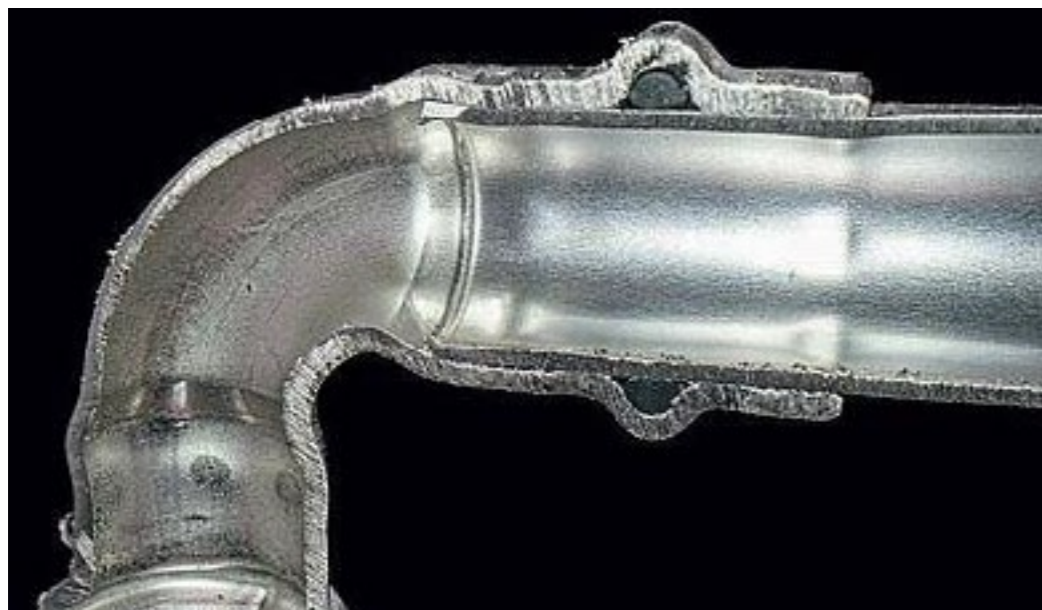
Brak gratowania rur sprzyja gromadzeniu się zanieczyszczeń, szczególnie przy zmianach kierunku przepływu medium
