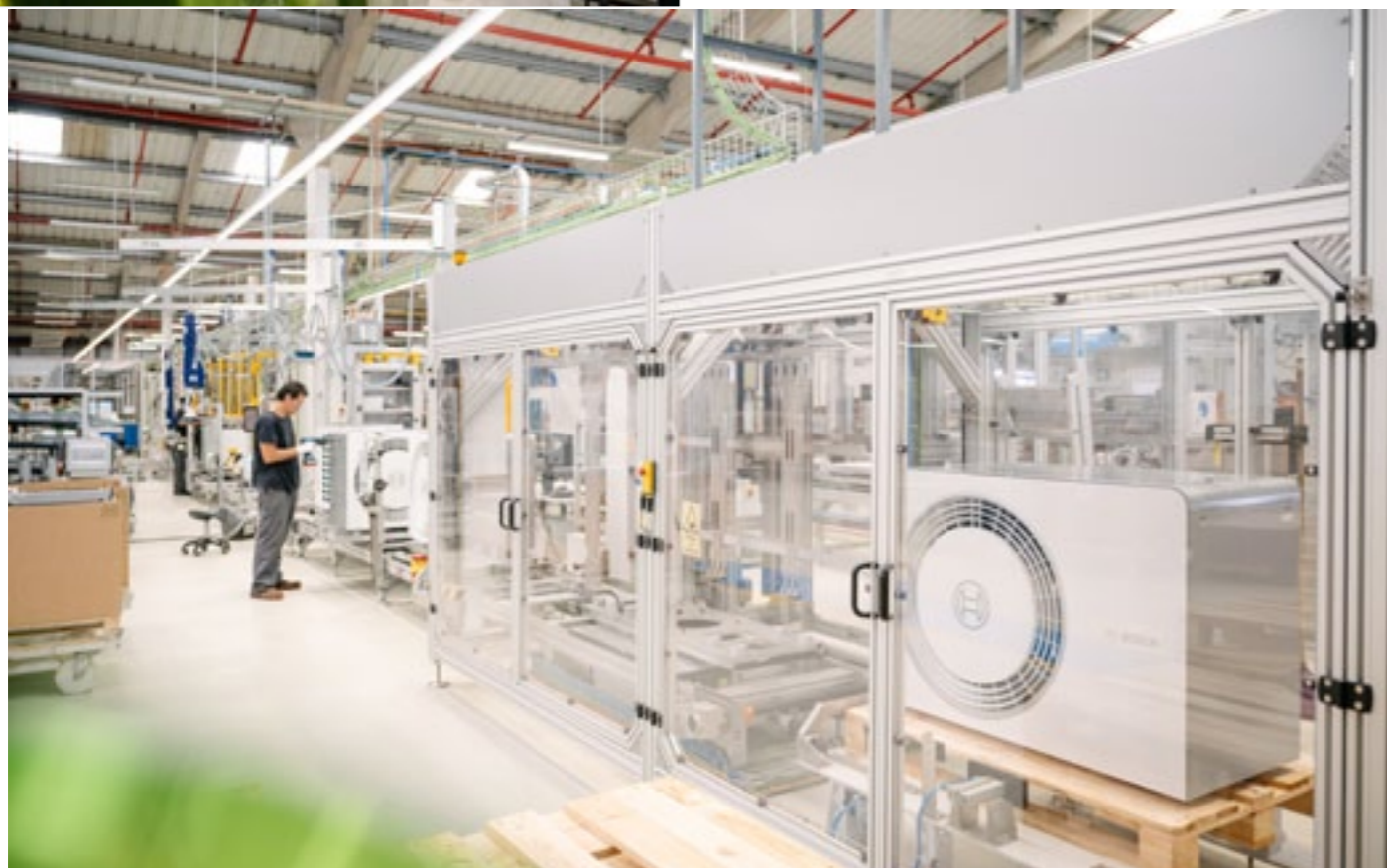
Linia produkcyjna pomp ciepła Bosch Compress 5800i AW/6800i AW w Aviero
