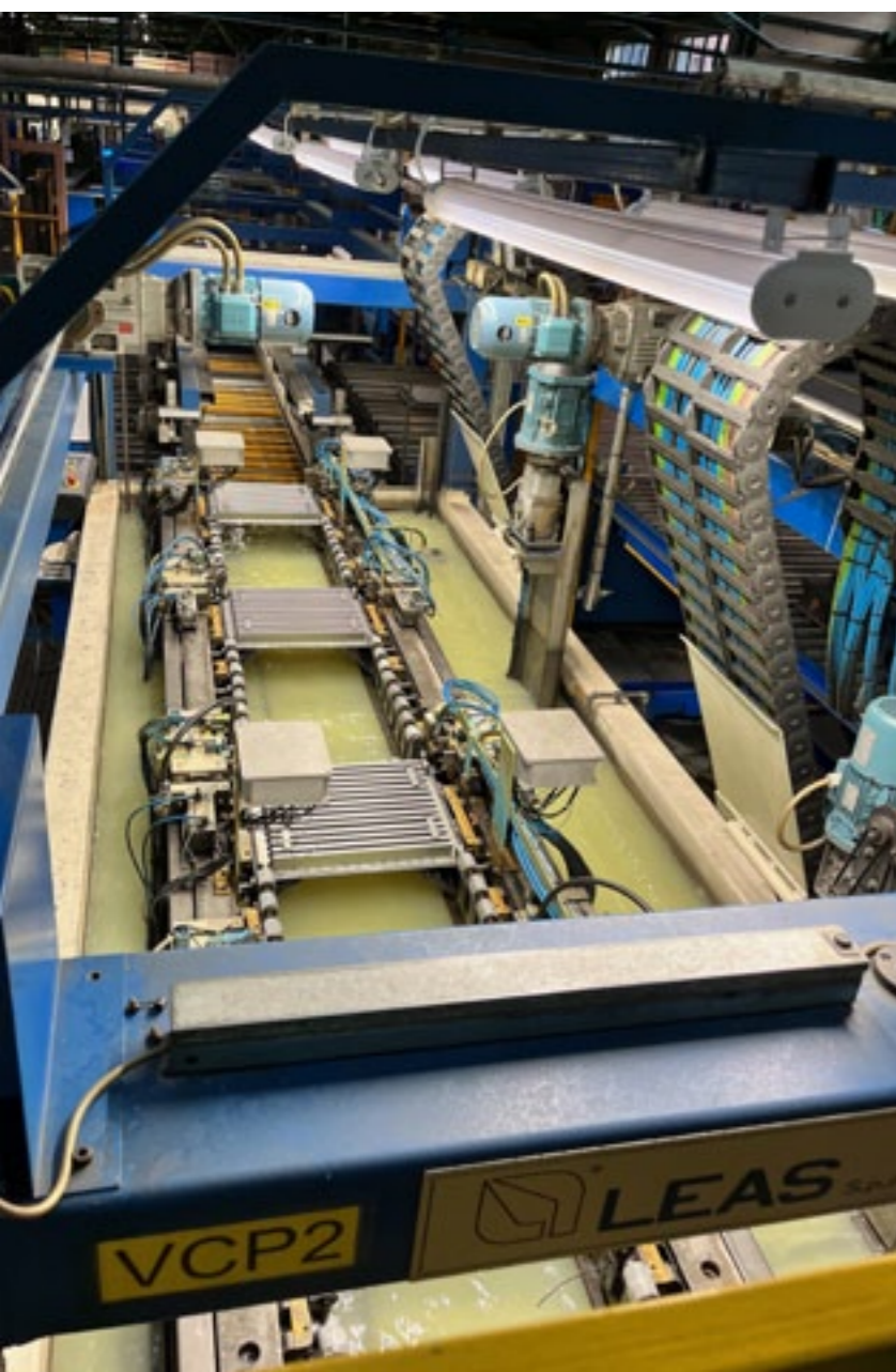
Sprawdzanie szczelności grzejników
