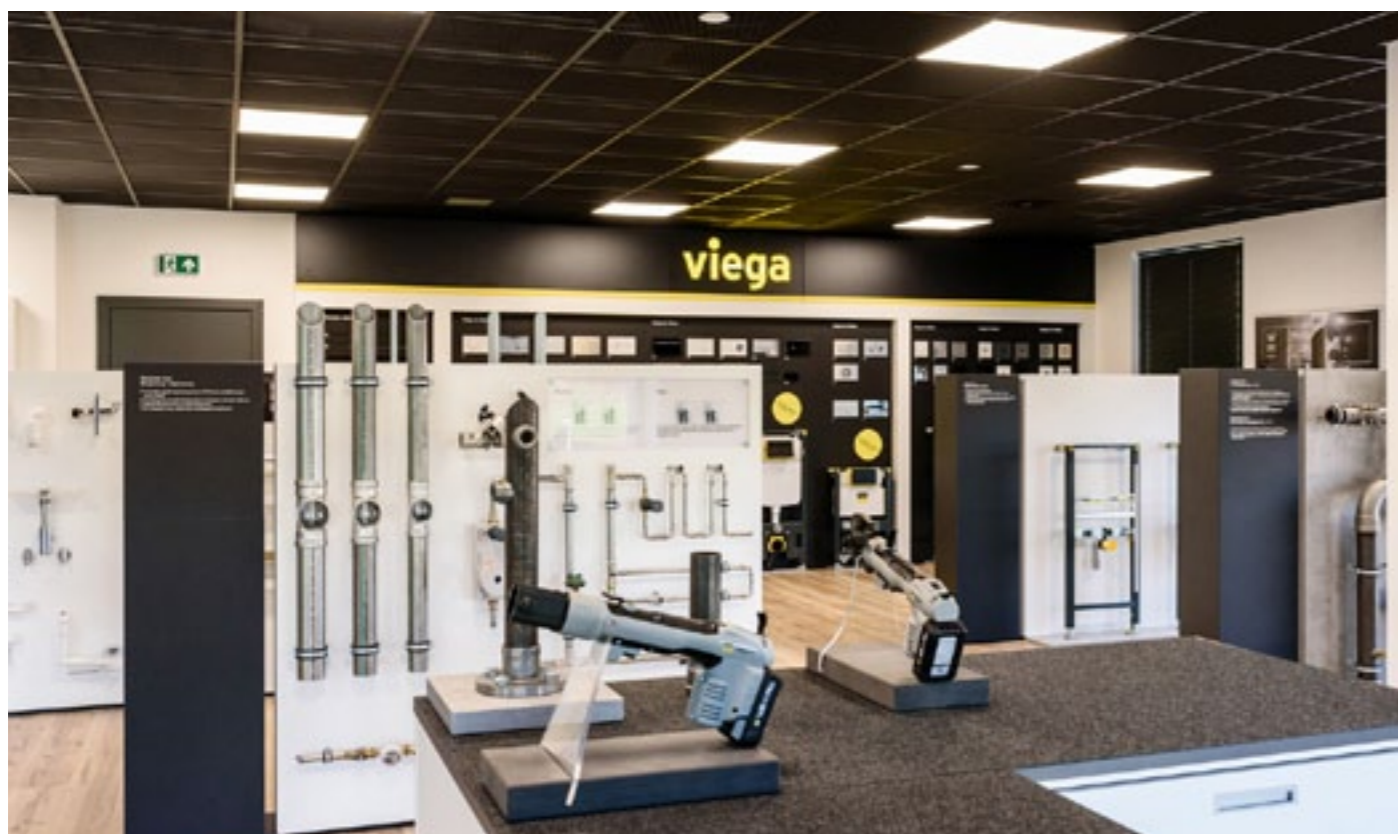
Uczestnicy warsztatów mają do dyspozycji stanowisko monterskie, przy którym mogą sami wykonać połączenia zaprasowywane
