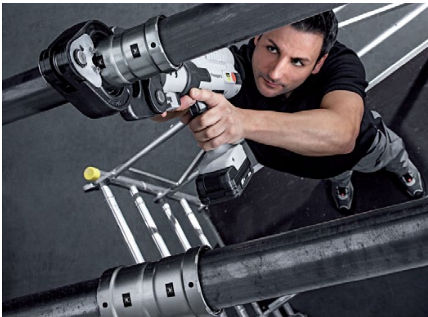
Technika zaprasowywania skraca czas instalacji nawet o 80% w porównaniu ze spawaniem rur o dużych średnicach
