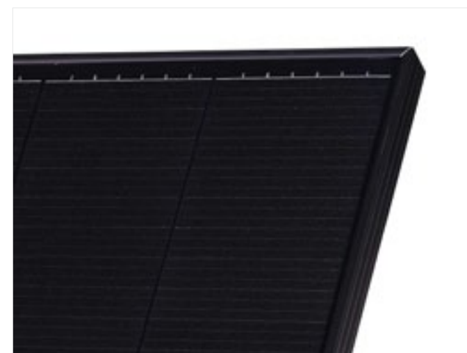
Moduł wykonany w technologii gontowej. Charakteryzuje się jednymi z najniższych współczynników temperaturowych oraz dużą elastycznością pracy przy częściowym zacieleniu. Niemal cała powierzchnia modułu stanowi powierzchnia czynna. Współczynnik wypełnienia FF>0,78
