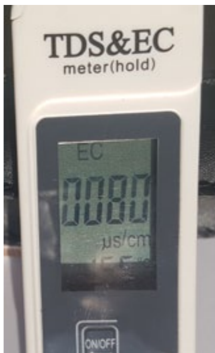
8 Wartość przewodności elektrycznej po procesie zmiękczenia, a następnie demineralizacji
