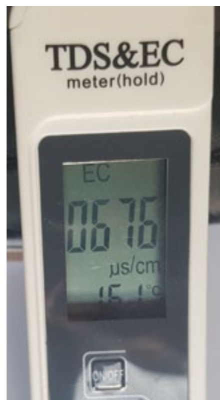
3 Przewodność elektryczna po zmiękczeniu
