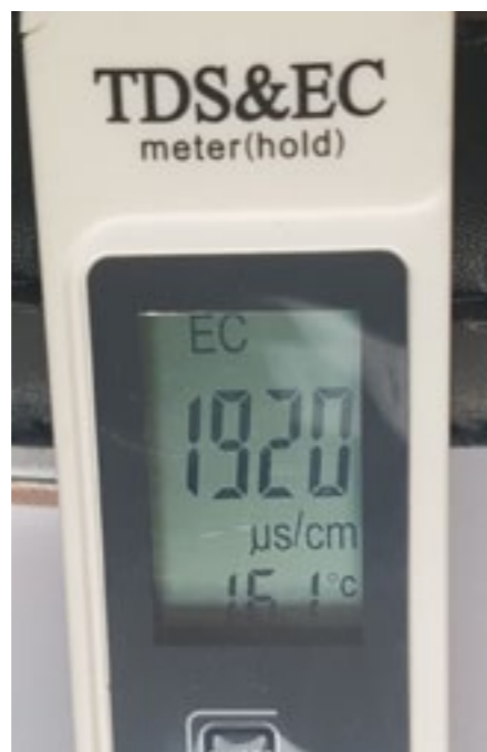
7 Wartość przewodności elektrycznej w „instalacji napełnionej wodą z własnego ujęcia” po kilku tygodniach pracy
