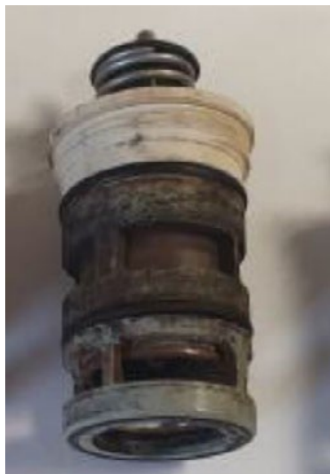
5 Osad związków żelaza powodujący uszkodzenie mechanizmu zaworu trójdrogowego
