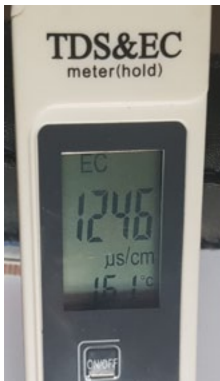
6 Przewodność elektryczna wody z własnego ujęcia przed zmiękczeniem
