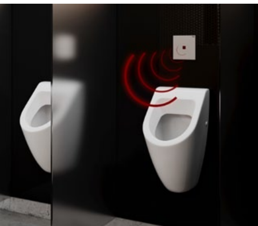
Bezdotykowe spłukiwanie jest uruchamiane, gdy użytkownik znajduje się w zasięgu czujnika podczerwieni przez minimum 8 sekund. Zarówno zasięg, jak i objętość spłukiwania mogą być regulowane w zależności od potrzeb
