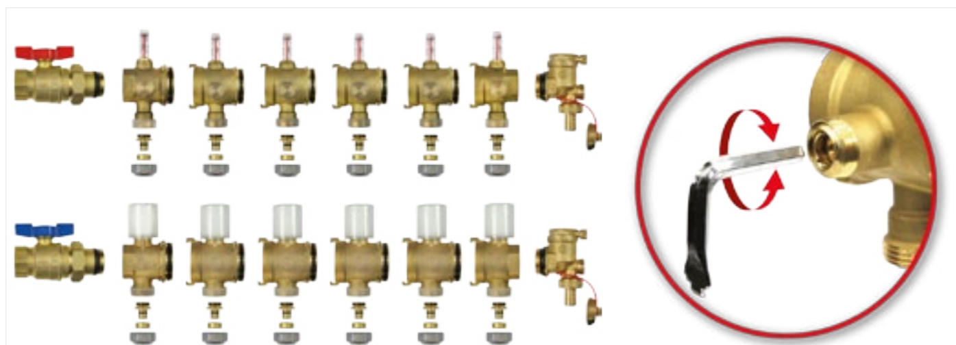
1 Rozdzielacz modułowy z zastosowanym równoważeniem statycznym (regulacją) poszczególnej pętli ogrzewania podłogowego
