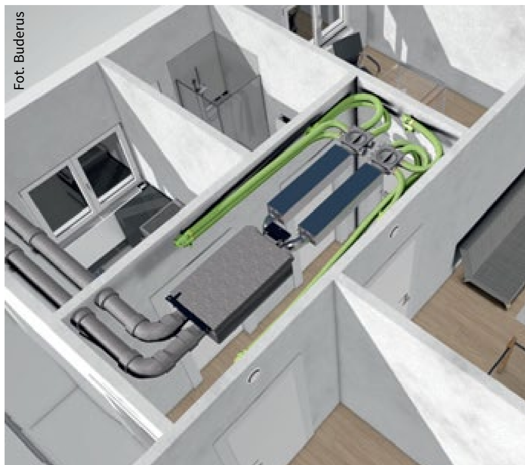
Montaż w suficie
