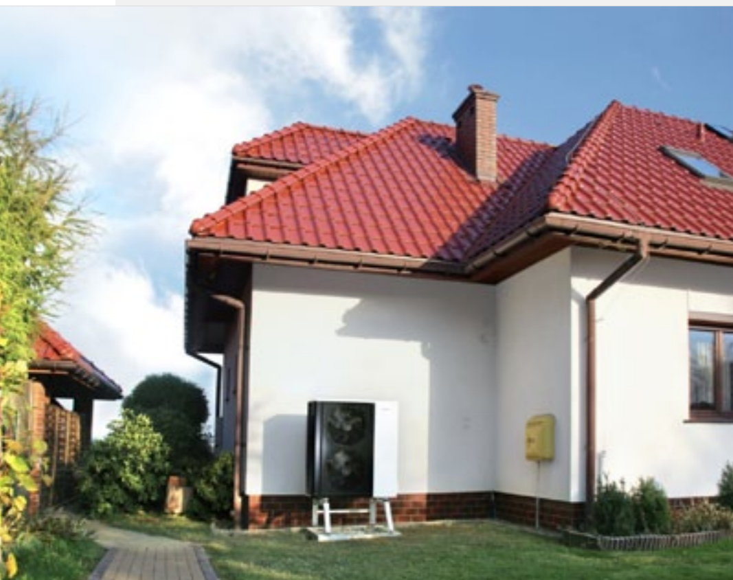
6 Jednostka zewnętrzna pompy ciepła w modernizowanym budynku [Źródło: materiały szkoleniowe Hewalex]
