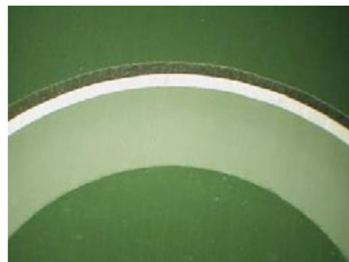
Rura bazowa Roth Alulaserplus z PE-RT otoczona warstwą aluminium zgrzewaną doczołowo laserem
