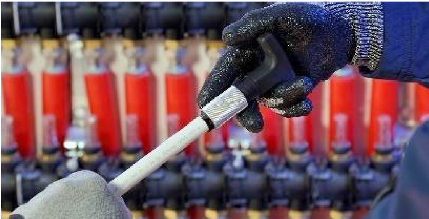
Przygotowanie rury za pomocą nowego narzędzia do kalibracji COMAP
