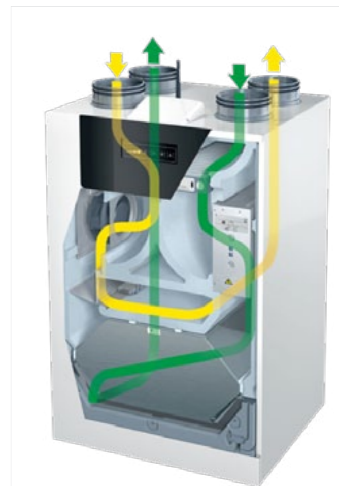
Eksplatacja latem (nocą): układ obejścia (by-pass) otwarty
