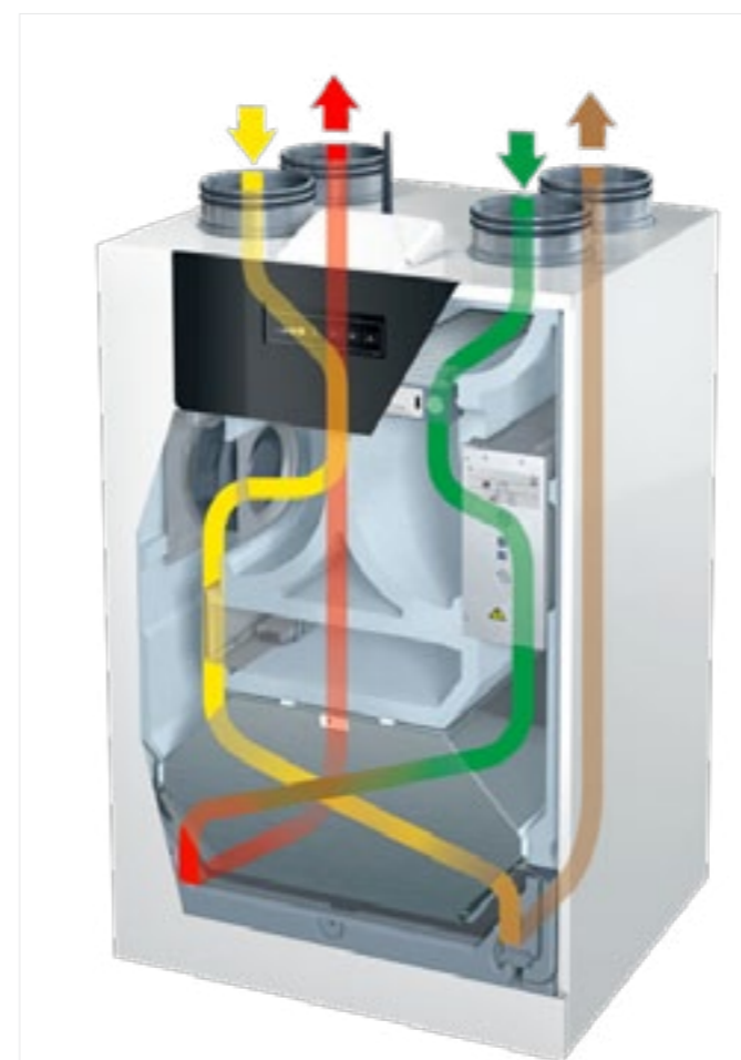
Eksplatacja zimą: efektywny odzysk ciepła
