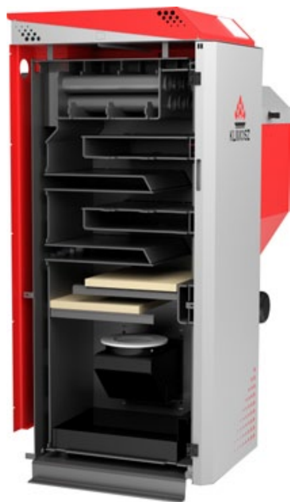
Kocioł retortowy w 5. klasie z poziomymi kanałami przepływu spalin o mocy 20 kW
