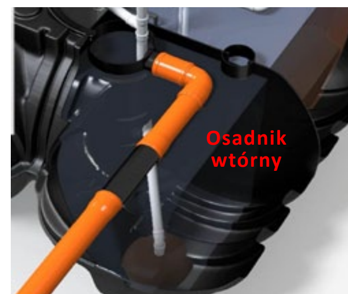
8 W osadniku wtórnym następuje rozproszenie biologicznie oczyszczonych ścieków a nadmierny osad osadza się na dnie
