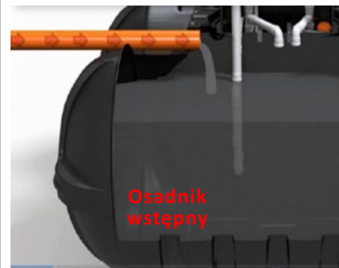
1 Dopływ ścieków z budynku do osadnika wstępnego grawitacyjnie i ich wstępna obróbka
