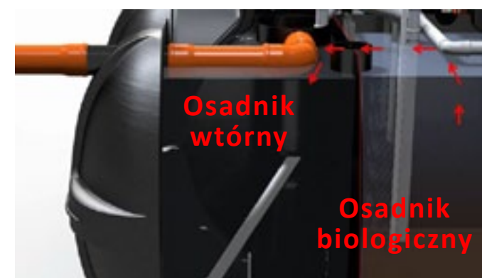
7 Przepływ oczyszczonej wody grawitacyjnie przez rurę oddzielającą z osadnika biologicznego do osadnika wtórnego
