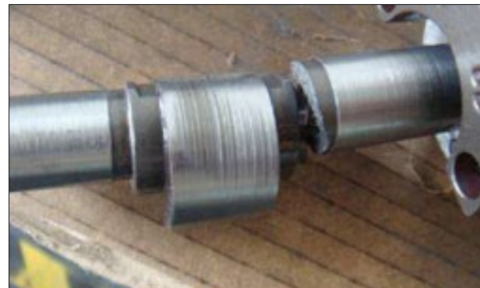
4 Złamanie zmęczeniowe tłoka sprężarki
