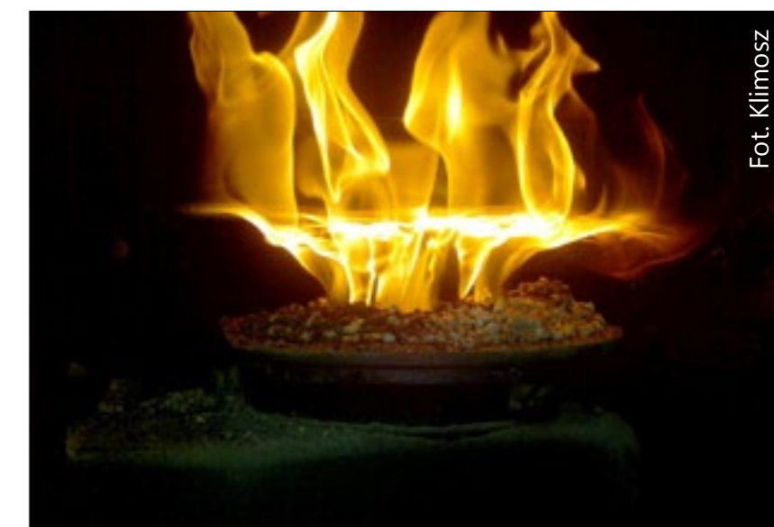
Palnik retortowy do spalania eko-groszku, pelet drzewnych, pelet z słonecznika, pestek z oliwek, pestek z wiśni
