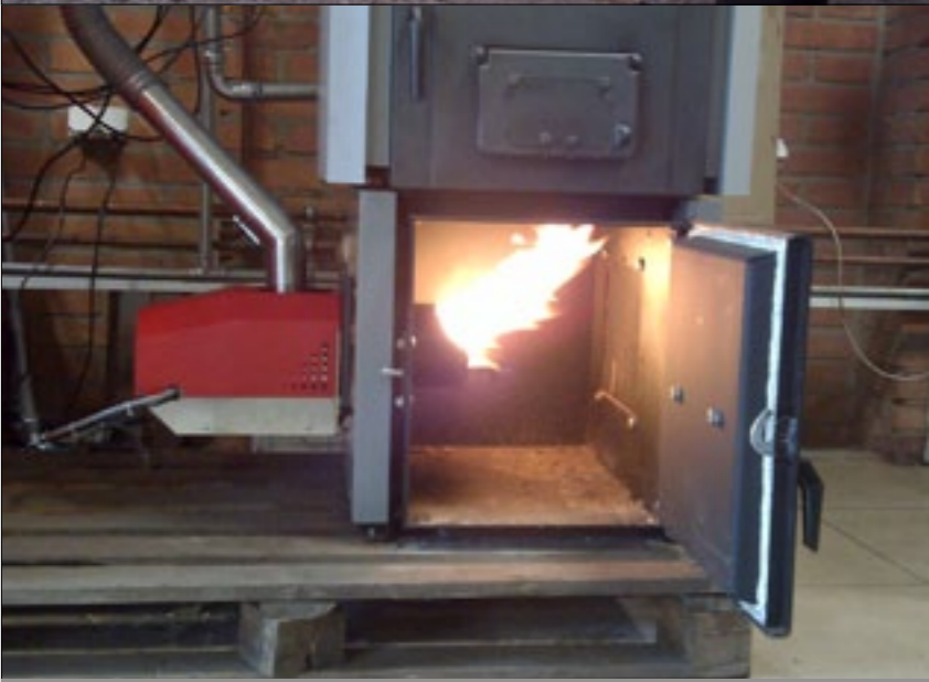
Palnik peletowy z samozapłonem oraz mechanicznym czyszczeniem dostępny również jako zestaw przebrojeniowy do kotłów Viadrus oraz Klimosz
