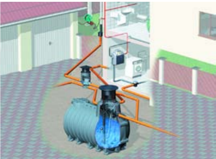
1 Zestaw KESSEL do zasilania instalacji w budynku z pompą w kompakcie sterowniczym
