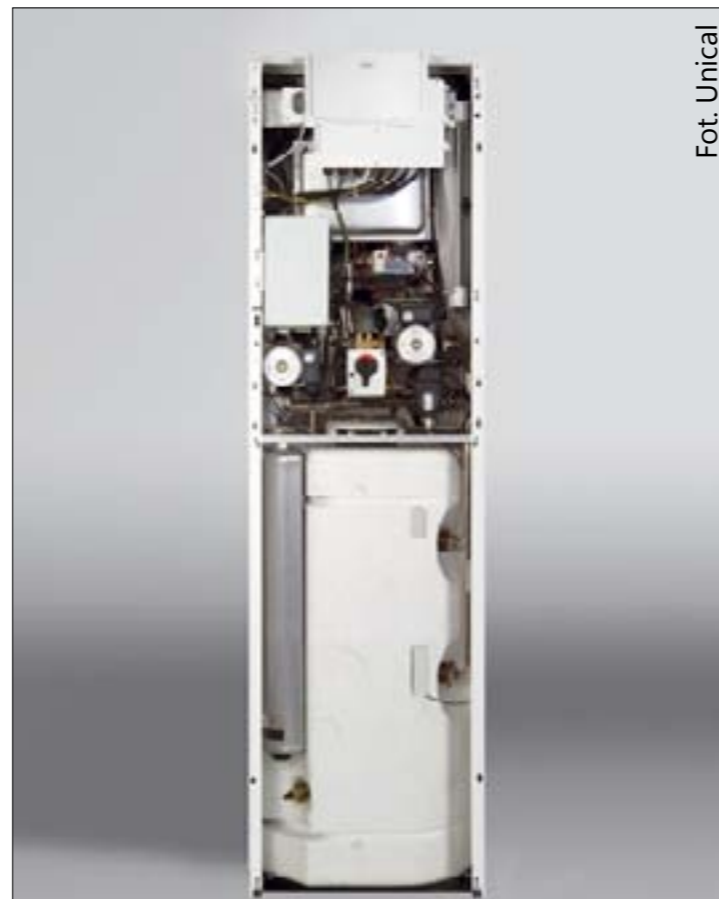
ALKON CLIPPER 28 - kocioł o mocy 28 kW z zamkniętą komorą spalania, wyposażony w zasobnik c.w.u. o pojemności 110 l ze stali nierdzewnej, sprawność 4 gwiazdki
