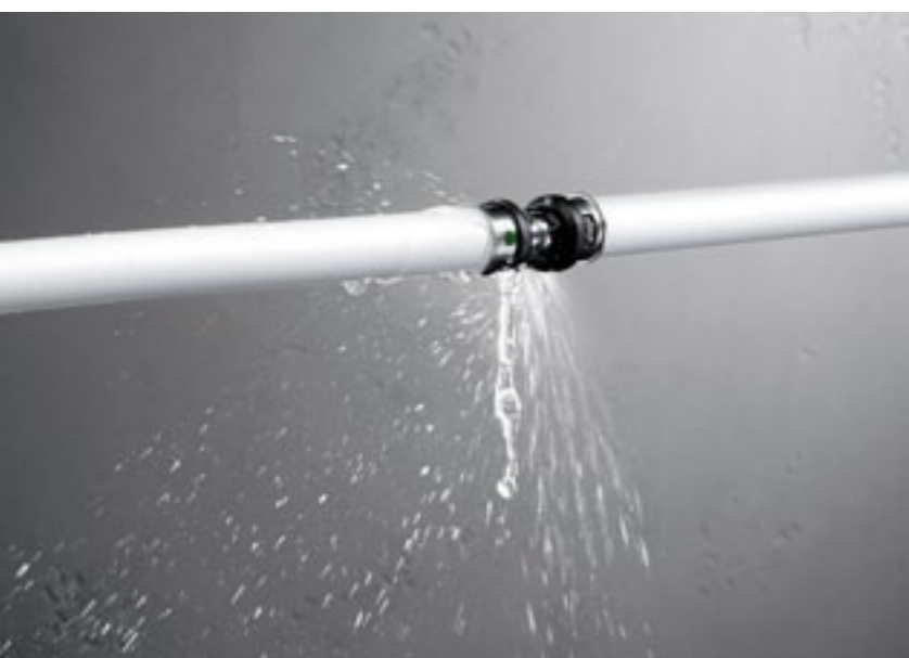
Złączki Viega Smartpress mają charakterystyczny dla wszystkich złączy Viega profil SC-Contur, który zapewnia natychmiastową widoczność niezaprasowanego połączenia
