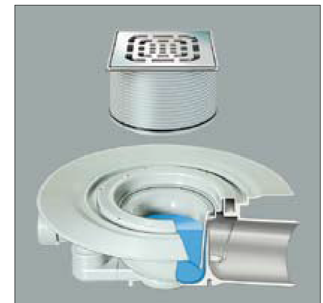
Odpływ z zamknięciem wodnym 50 mm wg EN 1259: umywalkowy i podłogowy
