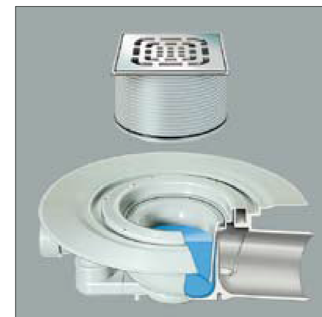
Odpływ z zamknięciem wodnym 50 mm wg EN 1259: umywalkowy i podłogowy
