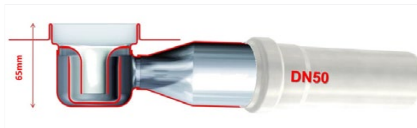
Odpływ z zamknięciem wodnym 50 mm wg EN 1259: umywalkowy i podłogowy
