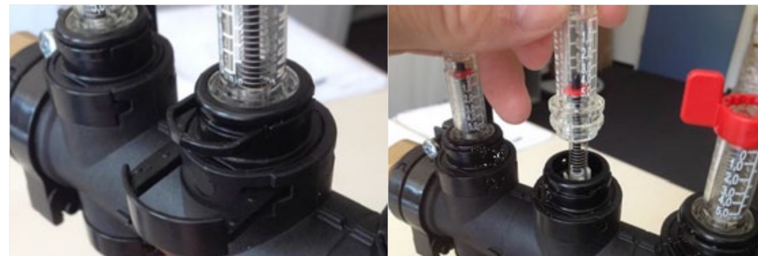
Bagnetowe wpięcie przepływomierzy w belkę rozdzielacza (specjalna konstrukcja zapewnia bezpieczne połączenie – brak wycieku, zawsze czyste szkło przepływomierza zapewniające odczyt)
