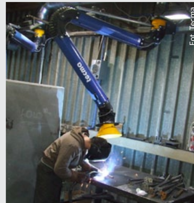
Działanie ramion wyciągowych (wersja z oświetleniem w ssawce)
