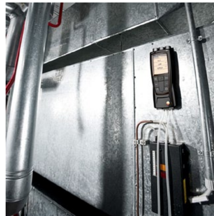
Pomiar różnicy ciśnień za pomocą miernika testo 480
