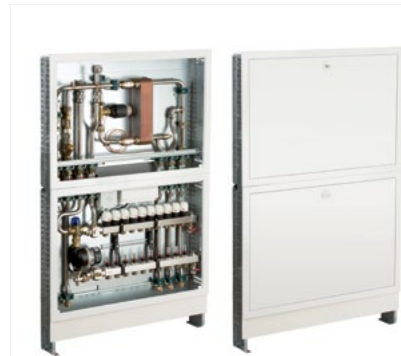
Mieszkaniowy węzeł ciepłny TacoTherm Dual Piko łączy zalety centralnego wytwarzania ciepła, jego centralnego rozdziału w pomieszczeniu oraz peryferyjnego podgrzewania przepływowej wody użytkowej w prefabrykowanym elemencie instalacji
