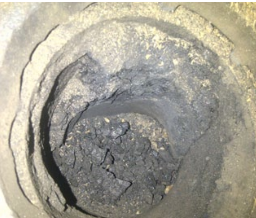
Nagar powstały podczas spalania pelet – widok kolana retorty z góry
