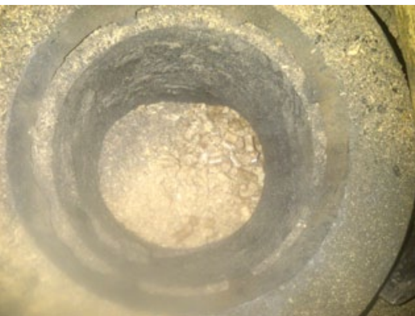
Palnik retortowy oczyszczony z nagaru – widok kolana retorty z góry
