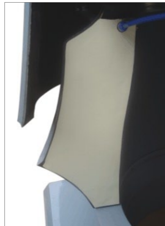
Przekrój wentylatora z widocznym materiałem dźwiękoizolacyjnym
