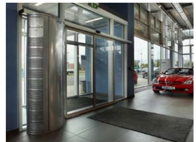
Kurtyna ARCUS-X – do drzwi przesuwanych, obudowa ze szczotkowanej stali nierdzewnej. Urządzenie pracuje uruchamiane sygnałem bezpotencjałowym wyprowadzonym z automatyki drzwi przesuwanych
