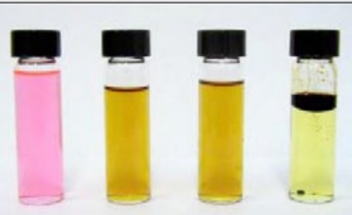
Przykład badania glikolu Tyfocor® LS – dla długotrwałego podgrzewania w temperaturze 235°C, po 1008 godzinach (42 doby), doszło do wytrącenia stałych frakcji i degradacji glikolu. Takie warunki pracy mogą występować w niektórych typach kolektorów próżniowych, w określonych warunkach długotrwałego ograniczenia odbioru ciepła w okresie letnim [1]
