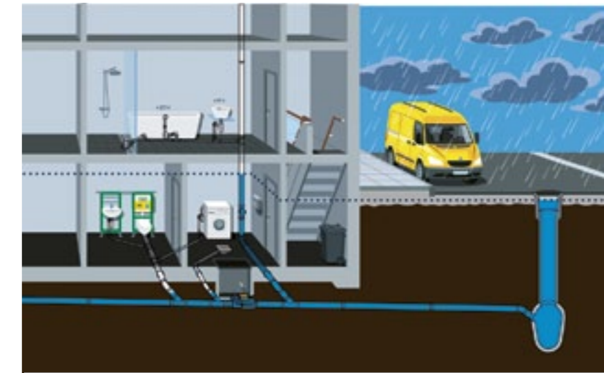
Zasawa zwrotna Grundfix Plus Control zabezpiecza piwnice przed zalaniem w przypadku ulewnych deszczy
