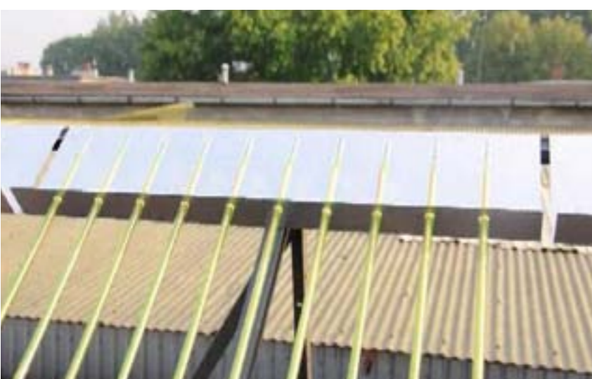
7 Prace badawcze firmy Hewalex na modelach szklanych rurek czynnika grzewczego. Odpowiednie natężenie przepływu (zalecane w materiałach montażowych) zabezpiecza kolektor przed ewentualnym zapowietrzaniem
