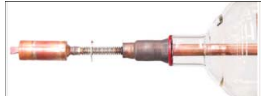
4 Bezpośrednie przejście rury miedzianej przez szkło. Technologia z powodzeniem stosowana przy produkcji solarnych rur próżniowych – wymaga elastycznego połączenia z kondensatorem z uwagi na geometrię połączenia i zastosowane materiały
