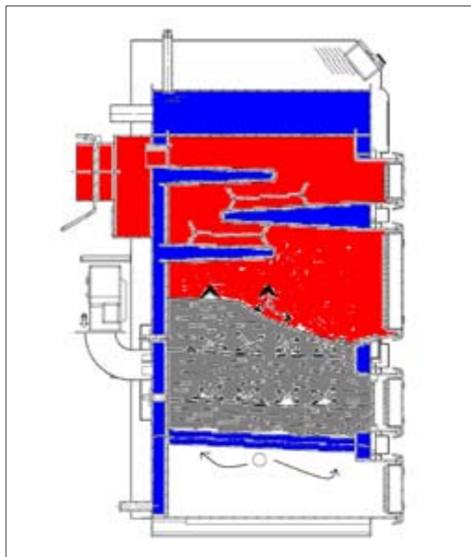
1 Kocioł rusztowy z nadmuchem bocznym, nadmuch od dołu spod rusztu wodnego oraz z góry i z boku w miarę wypalania się złoża. Opis: kolor niebieski – woda kotłowa, kolor czerwony – spaliny, kolor szary – złożo węgla, strzałki – kierunek nadmuchu powietrza
