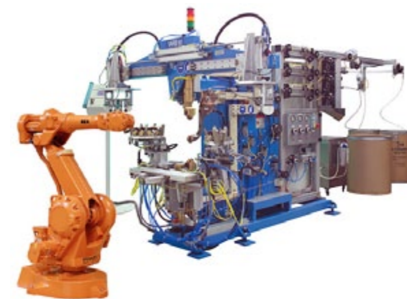
Zaawansowany technologicznie park maszynowy firmy Centrum Klima umożliwia produkcję okrągłych elementów systemów wentylacyjnych wysokiej jakości
