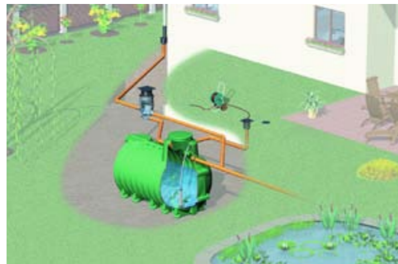
2 Zestaw KESSEL do nawadniania ogrodów z pompą zanurzeniową w zbiorniku wody deszczowej
