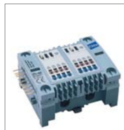
Rozszerzeniowy moduł siłowników 230 V lub 24 V umożliwia podpięcie dodatkowych max 8 siłowników. Siłowniki mogą być przypisane do jednego lub dwóch termostatów pokojowych podłączonych do listwy
