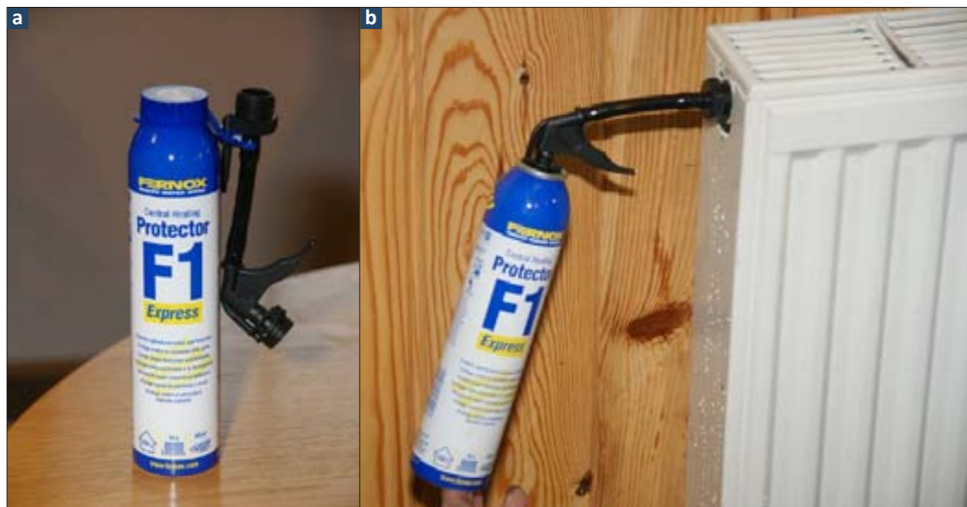
8 Inhibitor korozji do zabezpieczania pracujących instalacji ogrzewczych Fernox F1: a widok preparatu w sprayu, b sposób wprowadzania inhibitora poprzez otwór od odpowietrznika grzejnika do wnętrza instalacji centralnego ogrzewania
