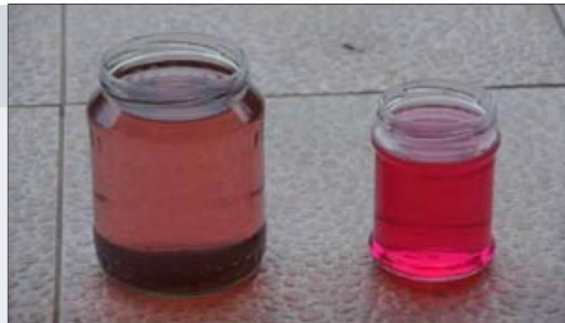
5 Widok płynu DS40 stosowanego do płukania i czyszczenia instalacji centralnego ogrzewania: z lewej strony próbka płynu po przeprowadzonym płukaniu, z prawej próbka porównawcza czystego płynu
