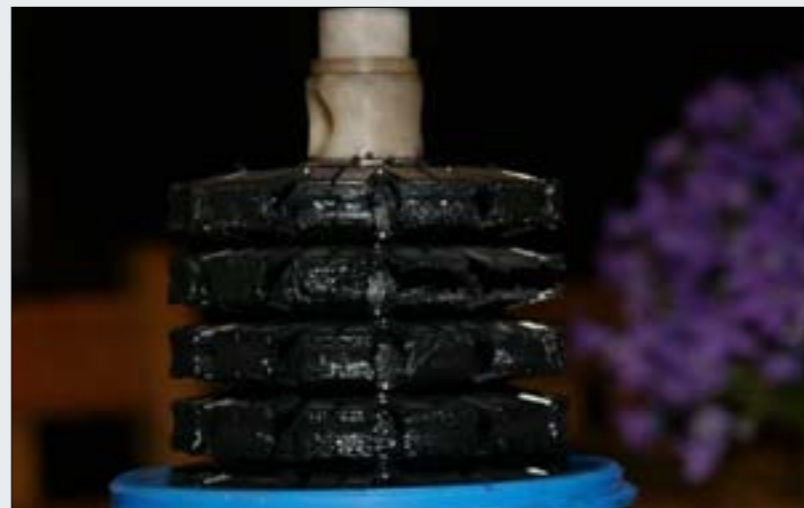
6 Widok wnętrza filtra cząstek stałych z widocznym zatrzymanym osadem pochodzącym z płukania instalacji grzewczej
