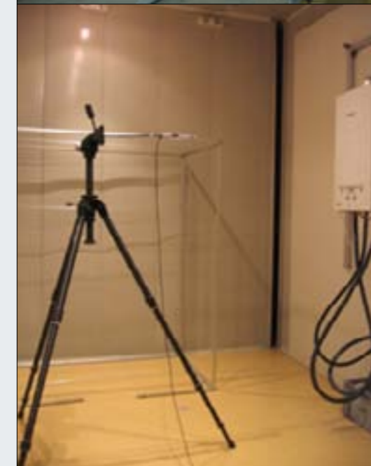
Stanowiska do badania parametrów pracy kotła
