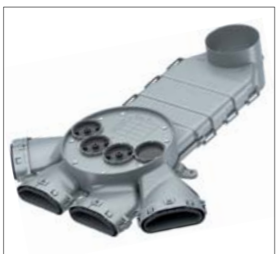
Kompletny rozdzielacz powietrza z czterema wyjściami do podłączenia płaskich elastycznych kanałów LVE RP 20 i jednym przyłączem głównym. Wykonany z tworzywa sztucznego odpornego na korozję, bezwonnego. Wyposażony w otwór rewizyjny i 4 kłapy do regulacji wielkości strumienia przepływu powietrza
