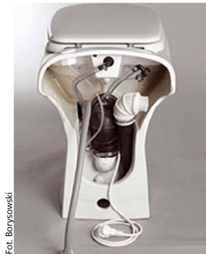
Miska ustępowa podciśnieniowa z pompą ścieków i maceratorem skrytym w konstrukcji miski
