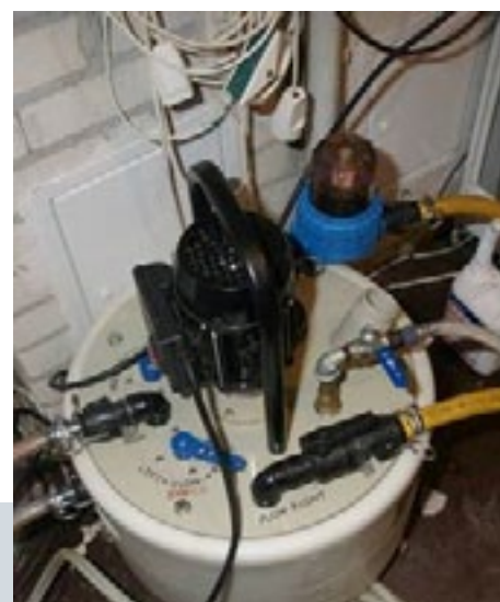
Do skutecznego płukania instalacji warto zastosować specjalnie zaprojektowaną do tego celu pompę ze zbiornikiem na środki chemiczne
