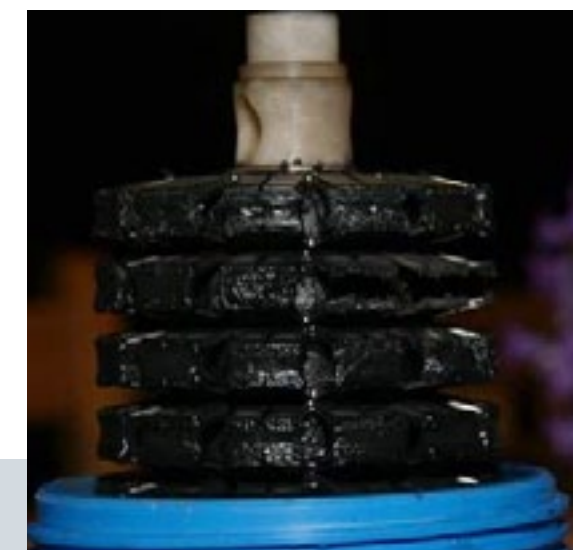
Zanieczyszczenia osadzające się na filtrze pompy płuczącej podczas pracy. W niektórych instalacjach filtr musi być czyszczony kilka razy podczas płukania jednej instalacji
