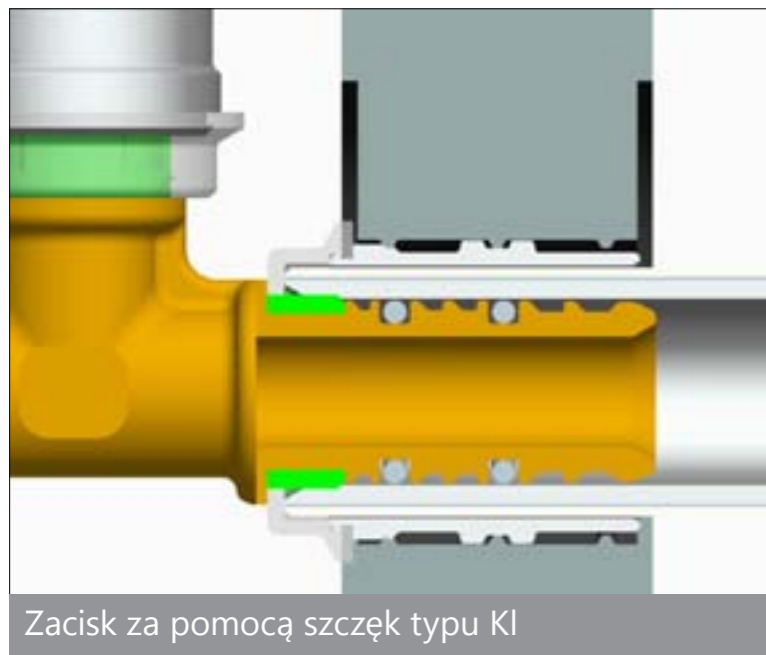
Przekrój przez złącze Kisan WL
