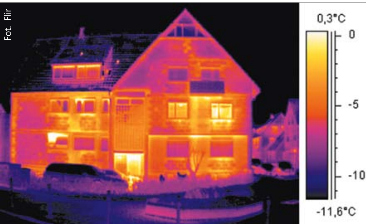
Niewysuszone ściany jednowarstwowe mogą tracić wielokrotnie więcej energii niż zakłada się w projekcie (zdjęcie wykonane kamerą termowizyjną)
