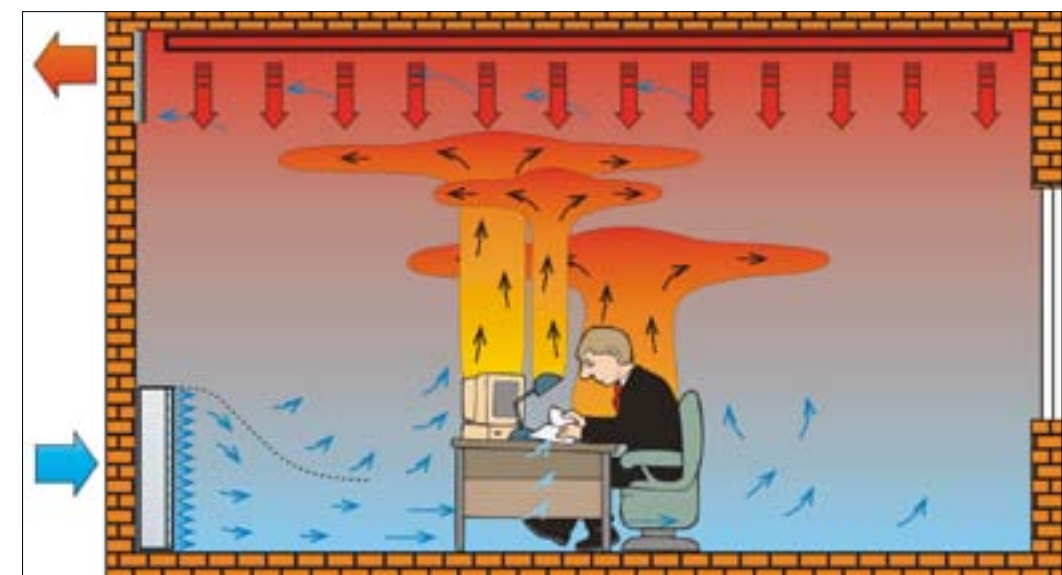
5 Wentylacja waporowa i sufitowe panele grzejne
