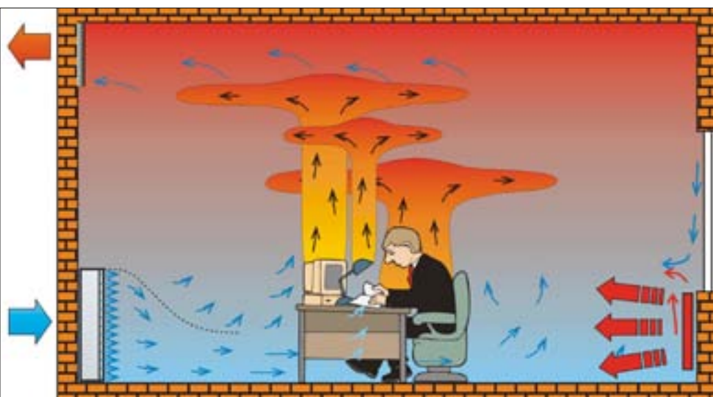
3 Wentylacja waporowa z grzejnikami radiacyjnymi
