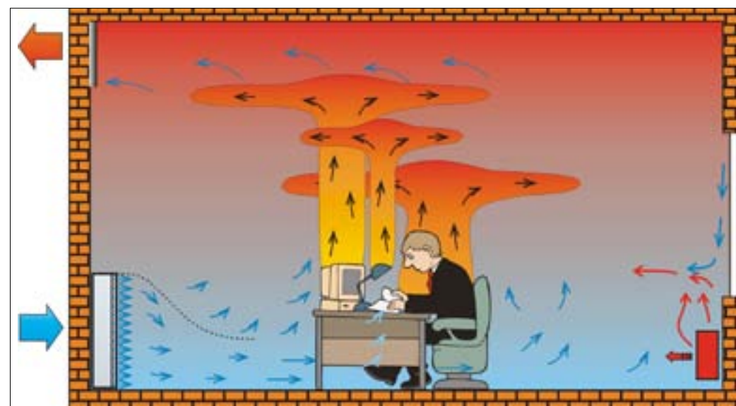
4 Wentylacja waporowa z grzejnikami konwekcyjnymi
