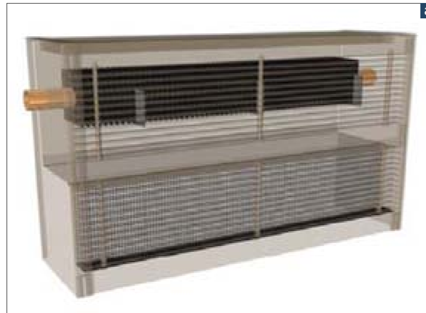
7 Element grzejny zintegrowany z nawiewnikiem wyporowym: a) DLE-H (Price), b) Q-SH (Krantz)
