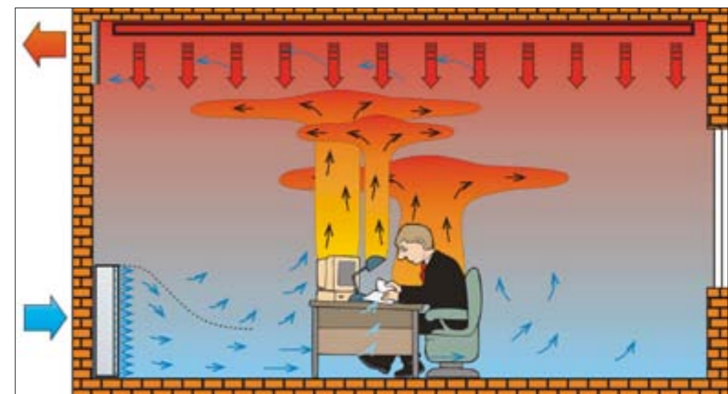
5 Wentylacja waporowa i sufitowe panele grzejne
