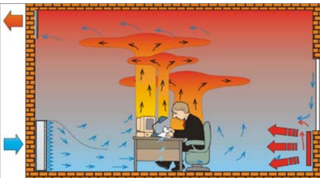
3 Wentylacja waporowa z grzejnikami radiacyjnymi
