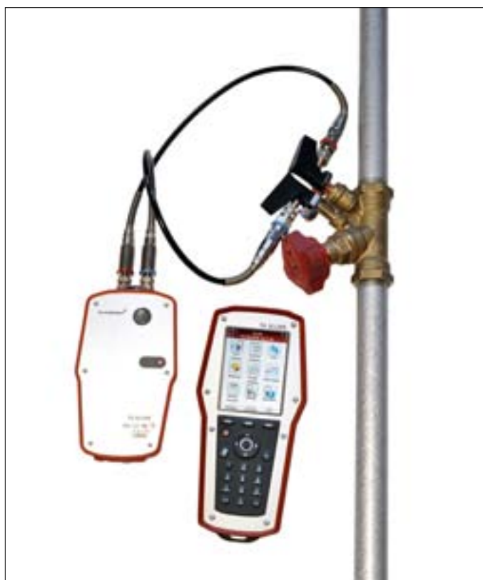
5 Urządzenie TA SCOPE do pomiarów i równoważenia hydraulicznego
