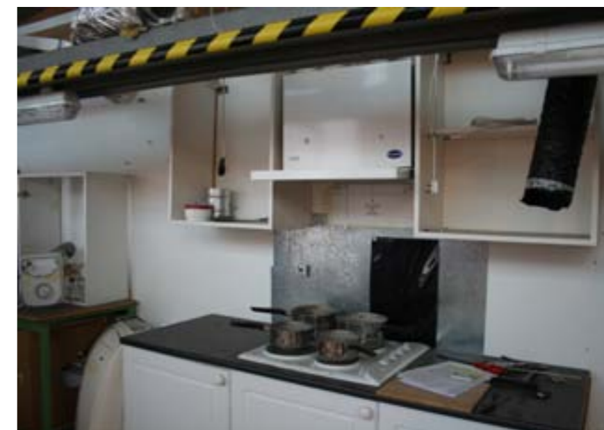
Stanowisko badawcze Kinetic – kompaktowego urządzenia do mechanicznej wentylacji i odzysku ciepła wraz z okapem kuchennym
