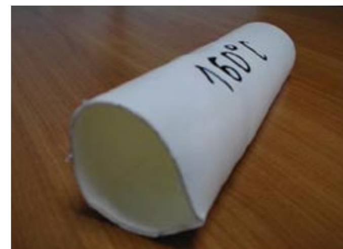
Zniszczenie rury z PCV po kontakcie z wysoką temperaturą
