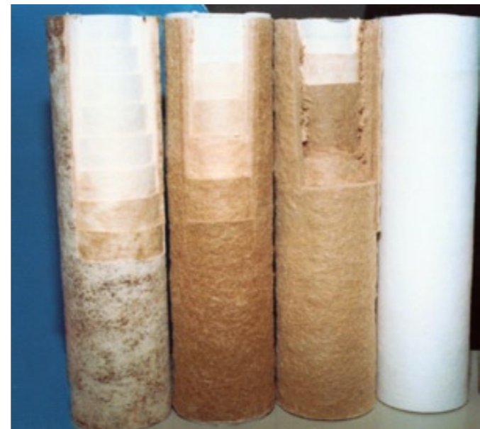
Wkłady MicroSpun z wielowarstwowej przędzy polipropylenowej w różnym stopniu zabicia osadami żelaza
